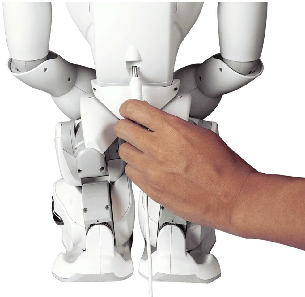
Une batterie pleine permet d'alimenter NAO de **45 à 90 min**, en fonction de ce que fait le robot.
